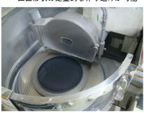
(Ⅱ) 平面度·平行度測定装置 最大□500mmの測定が可能
